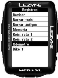
Reinicializar Contador kilométrico le permite suprimir las millas/kilómetros acumulados sobre el **contador kilométrico**.
